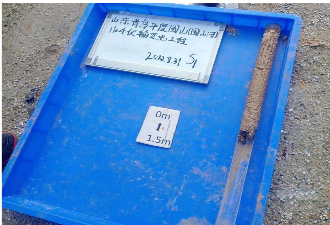
图 6-1 S1 钻孔岩芯照片
