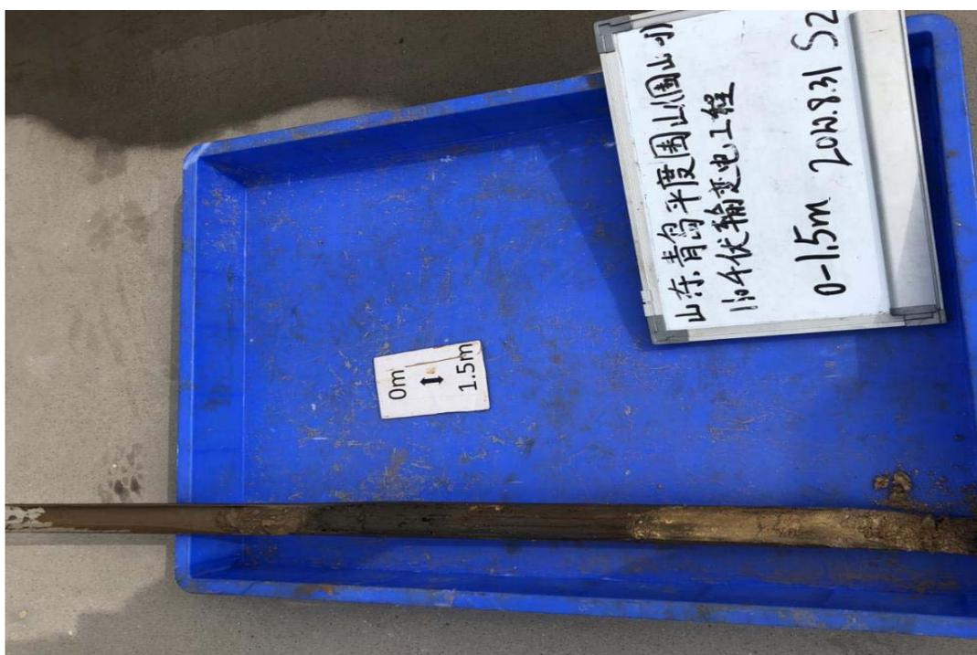
图 6-2 S2 钻孔岩芯照片
