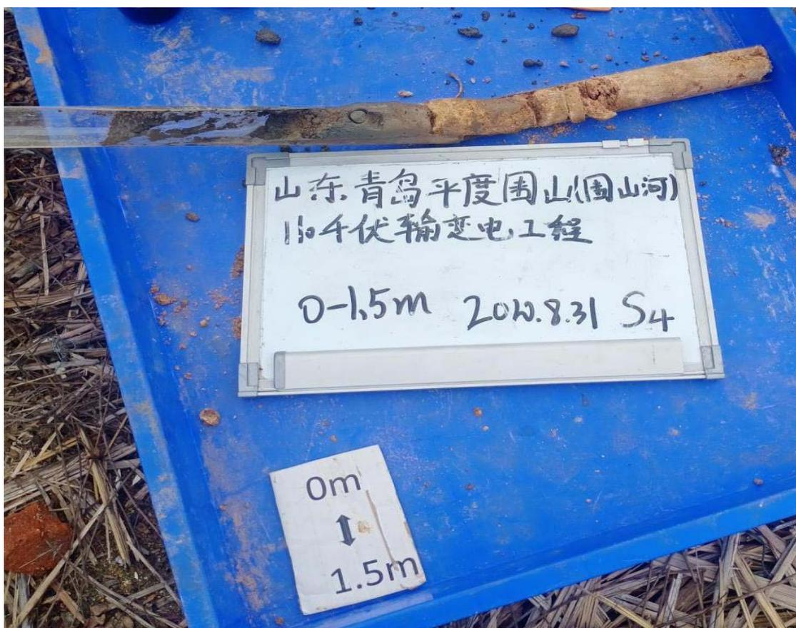
图 6-4 S4 钻孔岩芯照片
